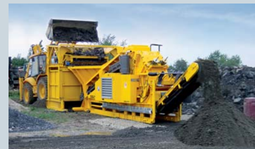
Weniger Verschleiß dank Vorabsiebung: das robuste VS60 - wahlweise mit Seitenförderband trennt - Feinanteile vom Aufgabegut
