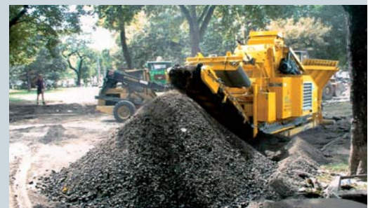
Bis 80 t/h kubisches Wertkom aus Bauschutt, Asphalt, Beton und im Gala-Bau - Erfolgsfaktor Qualität und Sortenreinheit
