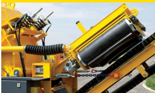
Unverzichtbar: Release-System zur Blockagenbeseitigung und zuverlässiger Magnetabscheider
