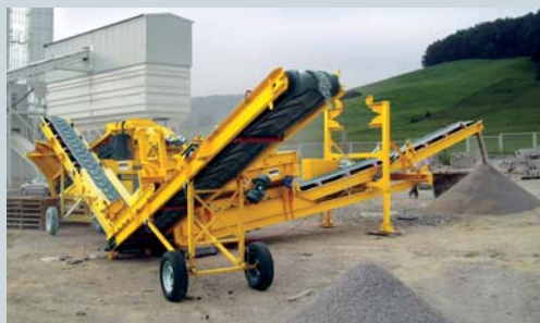
Profitable Nischen: Produktionsabfälle werden im containermobilen CS2500 klassifiziert und Kosten schonend wieder verwendet
