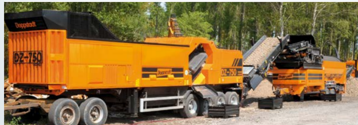
Altholzaufbereitung mit DZ 750 und SM 518
